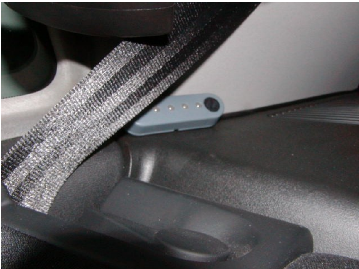
Bild 15: akustische + optische Abstandskontrolle montiert auf den rechten Seitenteil der Hutablage
